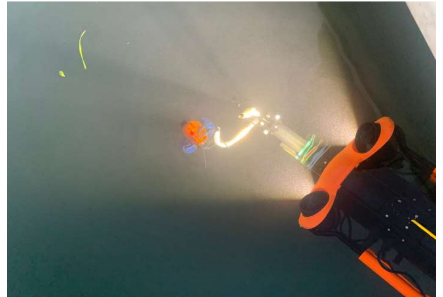
FIG 18 - ROV BATHYTEC ALLANT POSER UN CAPTEUR DE MOUVEMENTS À 60M DE FOND
