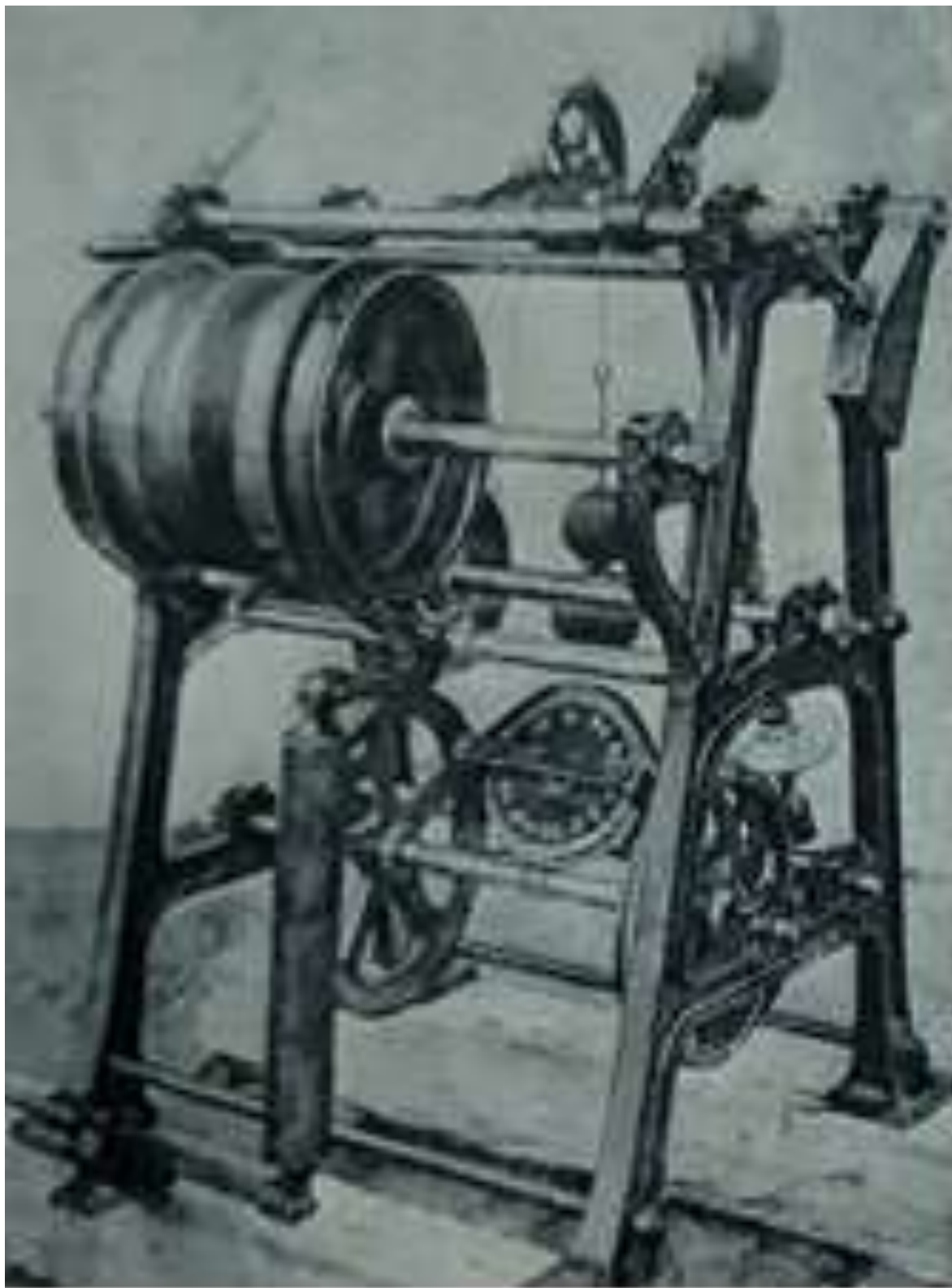
Fig 5 - Le sondeur Émile Belloc, 1890
