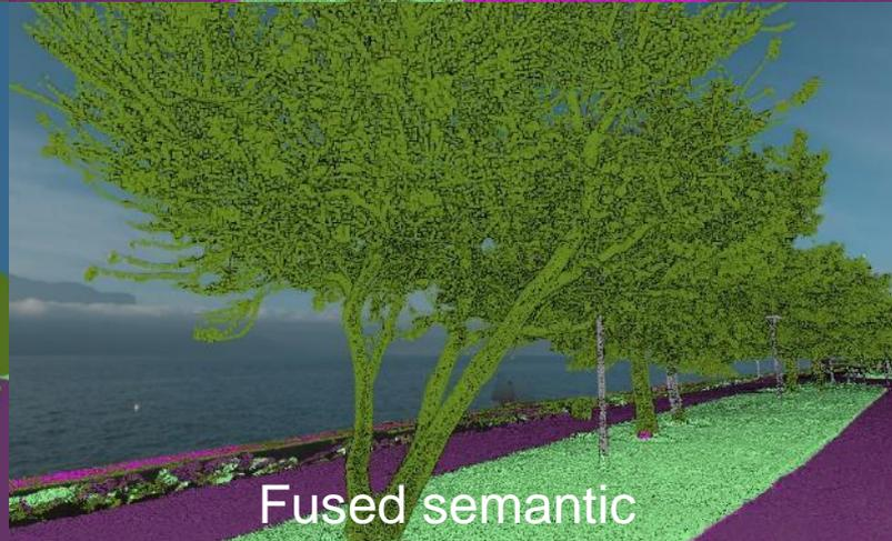
**Fusion image panoramique et LiDAR MMS pour la classification automatique**
