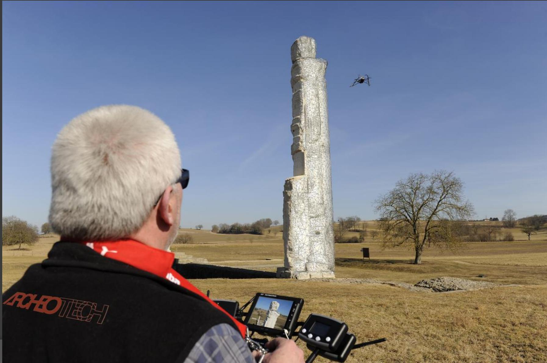
Saint-Maurice (VS) – Plan de vol pour le Falcon programmé pour réaliser un panorama sur les différentes positions avec la caméra inclinée à 30 ou 45 degrés suivant les hauteurs
