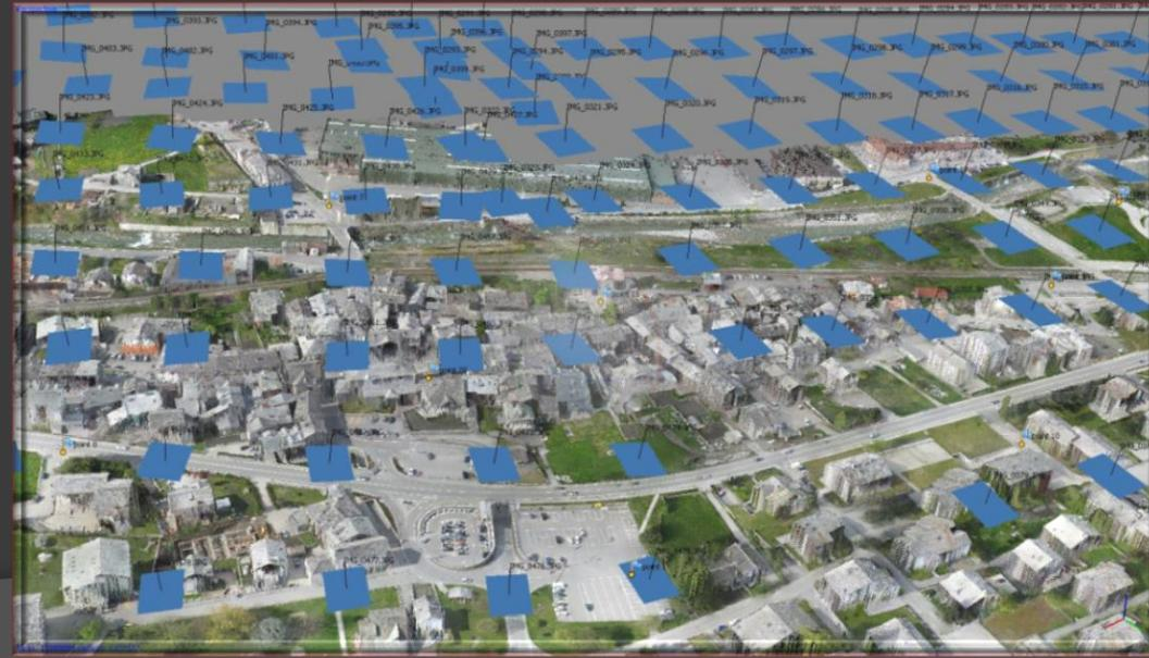
Le système ASCTEC Falcon 8 permet de mesurer dans les 3 axes de l'espace avec différents types de caméras; il se commande à vue et les photographies sont déclenchées par le pilote sur l'écran de contrôle ou par des plans de vols réguliers
