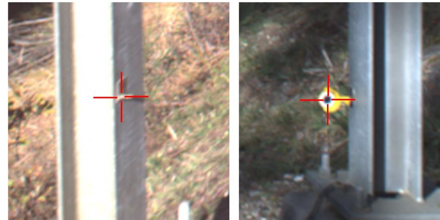
Beispiel Einmessung Passpunkt ohne Reflektor (links) und mit aufgesetztem Reflektor (rechts)
